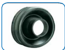
MODEL DU - manžety sú vyrobené z materiálu EPDM, rozmery manžety (vúťorné priemery) zodpovedajú vonkajším rozmerom chráničky a rúry s médiom. Vzhľadom na charakter materiálu možno počítať s ich rozmerovou flexibilitou.
